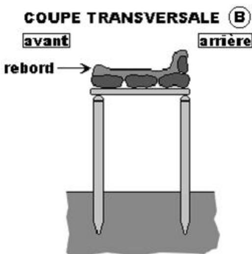
La solution est relativement simple, comme le montre la coupe transversale **B** : il suffit de donner une forme de cuvette au foyer en faisant un petit rebord à l'avant. Il est toujours
