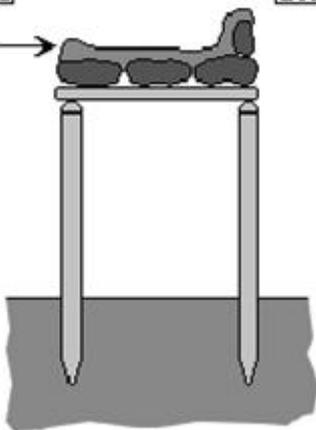
La solution est relativement simple, comme le montre la coupe transversale **B** : il suffit de donner une forme de cuvette au foyer en faisant un petit rebord à l'avant. Il est toujours facile d'ajouter du bois au feu mais le risque de braises qui tombent est bien réduit.
